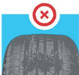
El dibujo que tienen las bandas de rodadura de un neumático no son adornos, sino que están diseñadas en forma y profundidad para que estos canales sirvan para desagotar el agua que queda entre la rueda y el pavimento, cuando el mismo está mojado. La profundidad mínima de los canales que deben conservar es de 1,6 mm.
