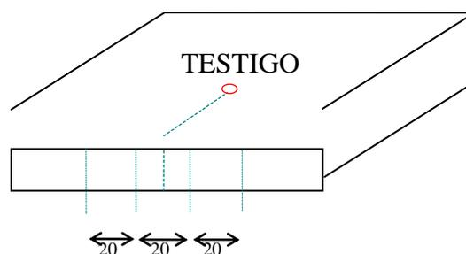
La determinación del espesor de un borde se efectuará sobre los puntos fijados en correspondencia con los testigos extraídos (Fig.2)
