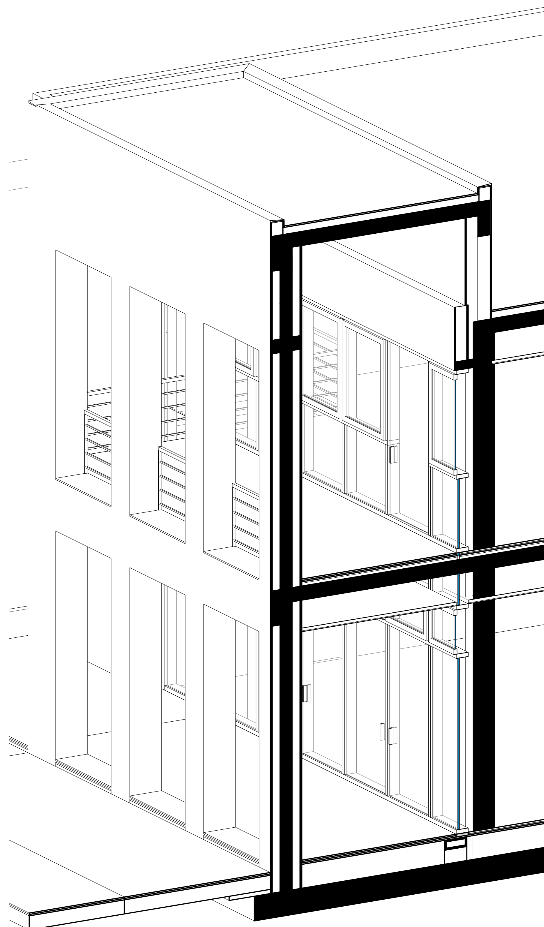
Perspectiva Detalle Pórtico Acceso Principal
