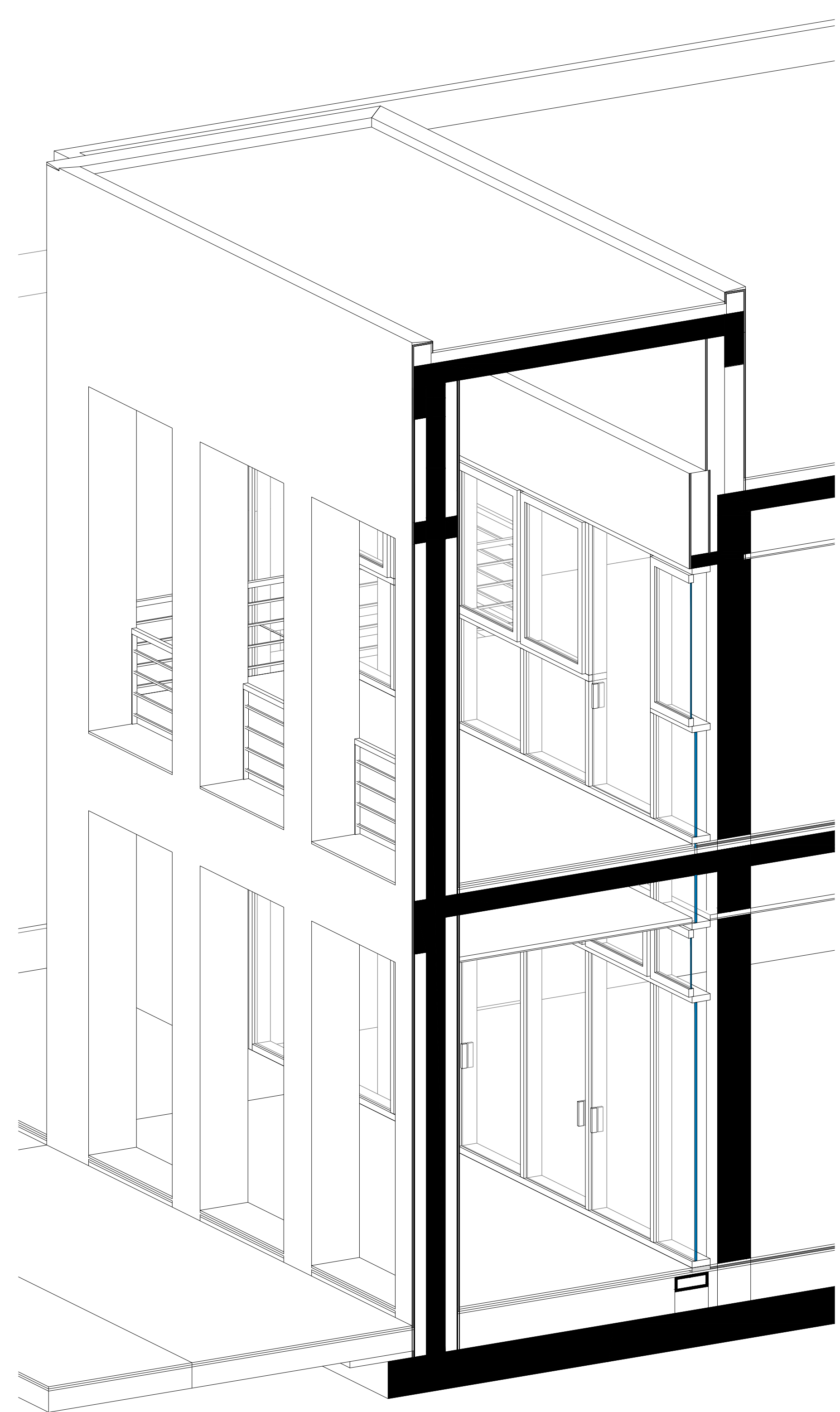
Perspectiva Detalle Pórtico Acceso Principal
