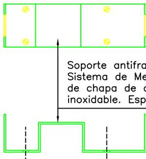
Soporte antifraude del Sistema de Medición de chapa de acero inoxidable. Esp: 1mm
